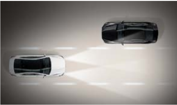
מערכת למעבר אוטומטי בין אור גבוה לנמוך (HBA) החלפה אוטומטית בין אור גבוה לנמוך בהתאם לתנאי הדרך, מונעת סינוור רכבים ומגבירה את הבטיחות בנהיגת לילה.
