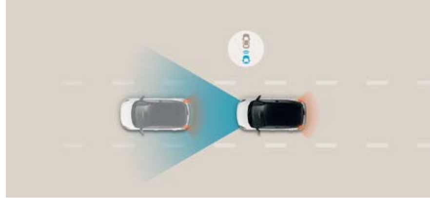
בלימה אוטונומית במצבי חירום (FCA) שילוב של מצלמה ורדאר המתריעים מפני סכנת התנגשות, ועצירה אקטיבית של הרכב במצב חירום.
