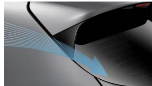
שיפורים אווירודינמיים התוספות החכמות בצדי הספילור האחורי, מקטינות את מקדם הגרר לשיפור צריכת הדלק, ובנוסף "מסך אוויר" מתקדם באזור הגלגלים משפר את זרימת האוויר סביב הגלגלים הקדמיים, כדי להציע לך חווית נהיגה נוחה בהרבה.
