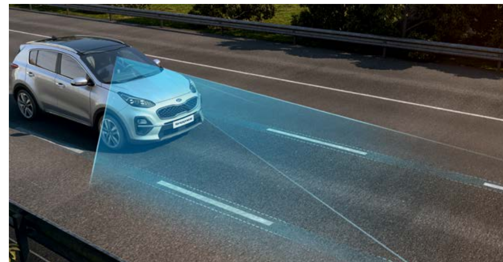
מערכת לשמירה על נתיב הנסיעה המבצעת תיקוני היגוי (LKA)
